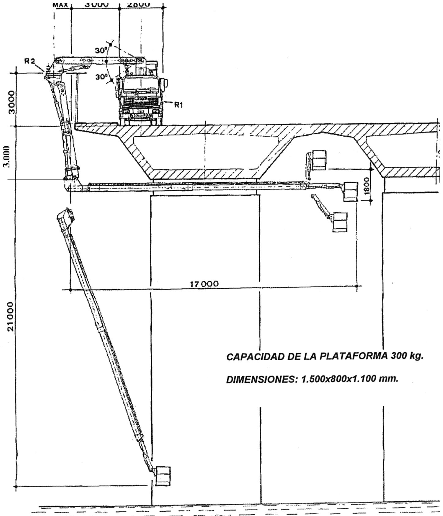
*Unidad para Inspección, Reparación y Mantenimiento de Puentes*
